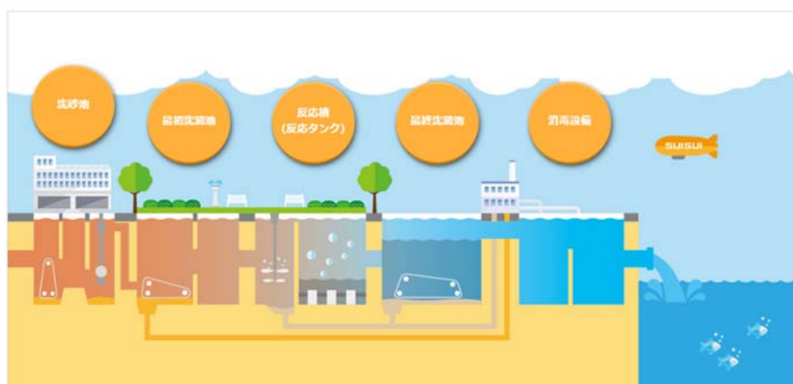
図 1 下水処理の仕組み
